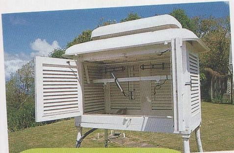
Un abri Stevenson contient les instruments de mesure de la pression atmosphérique, de la température et de l'humidité relative pour les informations locales.
